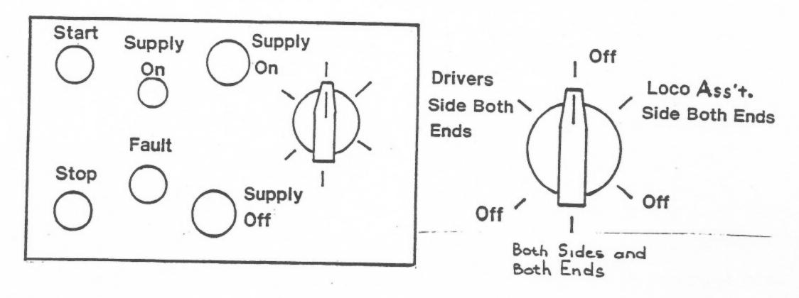
NOTE THE HEAD END POWER SOCKET SELECTION SWITCH IS ONLY LOCATED AT NO.1 END.
